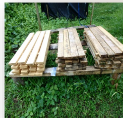
Figure 4: Observation du bleuissement sur l'expérimentation extérieure après un mois
